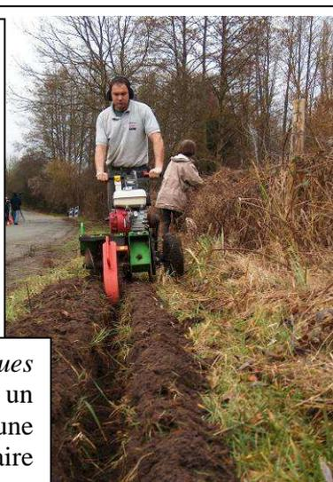
**La nouveauté 2011**, dans les moyens techniques utilisés, a été la location d'une « trancheuse », un engin à moteur qui ressemble à une « tronçonneuse sur roulettes », capable de faire une tranchée dans la terre de 9cm de large, par 25/30cm de profondeur, dimensions idéales pour enterrer la bâche plastique.
