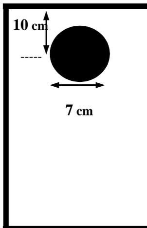
Le centre du trou d'entrée (d'envol) est à environ **10 cm** au-dessous du plafond.
